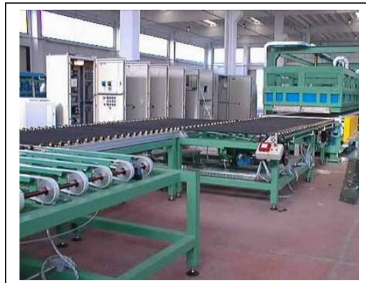
SEZIONE DI CARICO FORNO CON TERMOREGOLAZIONE GESTITA DA P.L.C.
