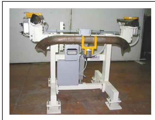
PREDISPOSIZIONE PARTICOLARI ASSALE AUTO A STAZIONE DI TAGLIO AL PLASMA ROBOTIZZATA
