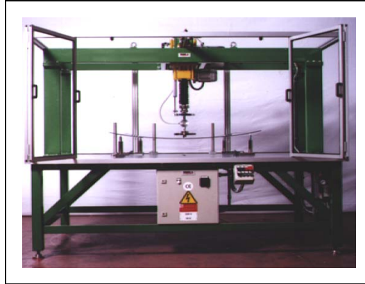
BANCO PROVA VETRO VERIFICA CARICO DI ROTTURA E FRECCIA FLESSIONE
